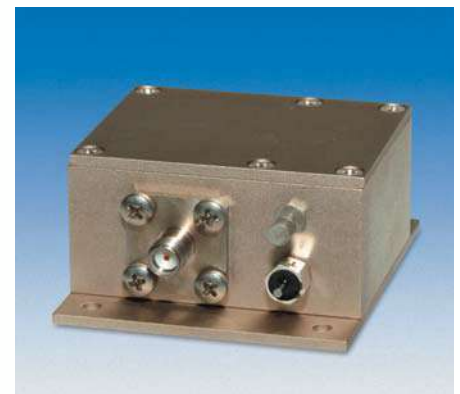
Ausführung 3 mit Standardbohrbild, HF-Buchsen nach Wahl inkl. Befestigungsmaterial sowie 1 Massepin und 1 Durchführungsfiter DF2
